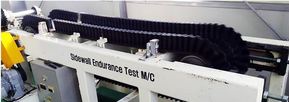
波棧屈曲試験機は波棧の耐久性能を測定する試験機で、実際、現場での運用の際に問題が発生しないように試験を通じて波棧の耐久寿命を測定することとともに耐久性の向上を推進しています。
