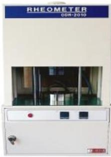
ゴムの硬化程度を決定するための試験機で特定の温度と圧力で試験片の回転トルクによる前端応力を測定する試験機です。
