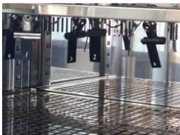
設定した温度でゴムの試験片を加熱させ、ゴムの老化させる試験機です。
