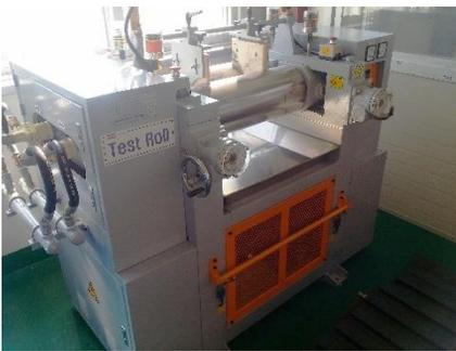
**▶ Coal Feeder & Feeder Belt 走行性能試験機**
