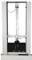
材料の変形に対する様々な抵抗性を測定する機械で、試験片の機械的、物理的性質をデータ化させ、材料の引張強度、伸び、接着強度など材料の物性を分析する試験機です。
